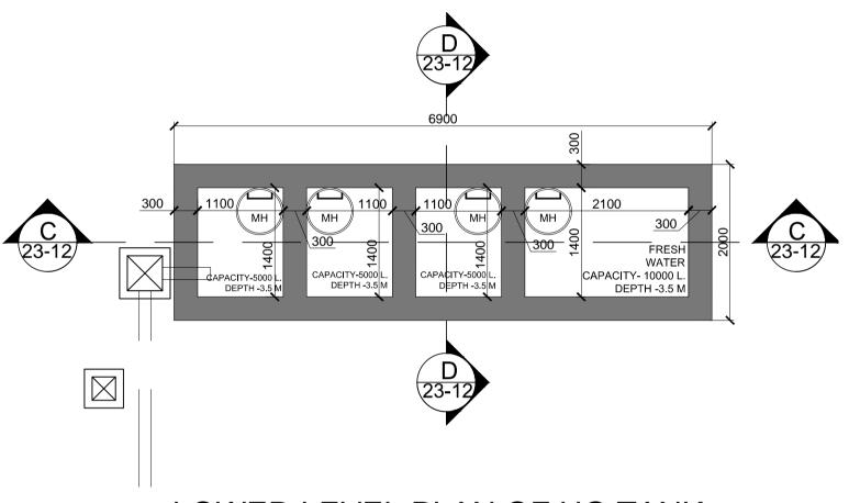
LOWER LEVEL PLAN OF UG TANK SCALE - 1:50
